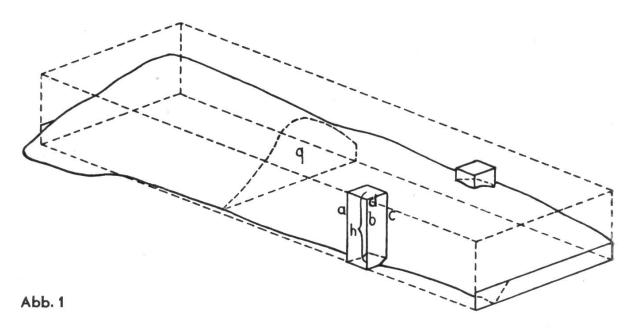
man den Luftfeil in Prismen mit quadratischer Deckfläche (1 m²) unterteilt und diese einzeln berechnet.
