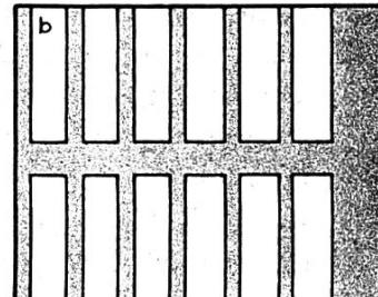
viele Pfosten und Bretter sind nötig, und wie sind die Pfosten zu setzen? — — — Es braucht immer 15 Brettbreiten für die verlangte Höhe. Ich verwende 10 Pfosten in der Anordnung der Abbildung und zwar in den Abständen von je 3 m auf die Pfostenmitte gemessen bei AB FG GH und IK (Massstab 1:250; für Schüler natürlich grösser); ferner bei CD und EF je 60 cm, sowie je Türbreite DE = 1 m. Bretterverbrauch:
