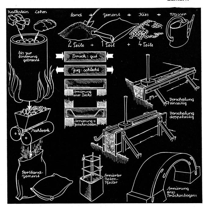
Herstellung: Gemahlener Kalkstein und Lehm zu Ziegeln geformt und im Ofen bis zur Sinterung gebrannt; dann fein gemahlen = künstliches Bindemittel.
