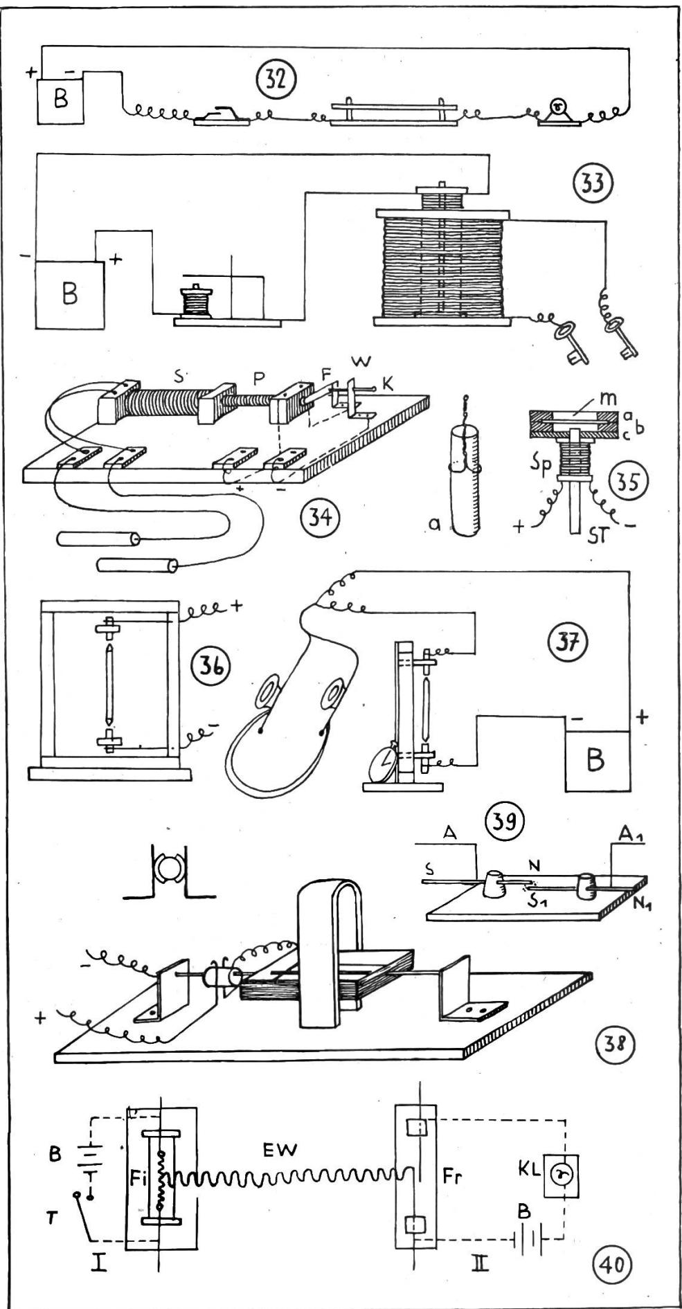
Besonders gerne wurde der Schlittenapparat nach Abb. 34 von den Schülern gebaut. Die Primärspule P enthält einen Weicheisenkern von 70 mm Länge, darnach lassen sich die übrigen Maße im Verhältnis leicht bestimmen. S = Sekundärspule — möglichst dünnen Draht — F = Feder mit Anker, K = Kontaktstift mit Spitze, W = Messingblechwinkel. Die Polklemmen sind nicht unbedingt nötig. Die Handgriffe sind Reste von Messing-Vorhangstangen, Anschlußdraht nach Abb. 34a.
