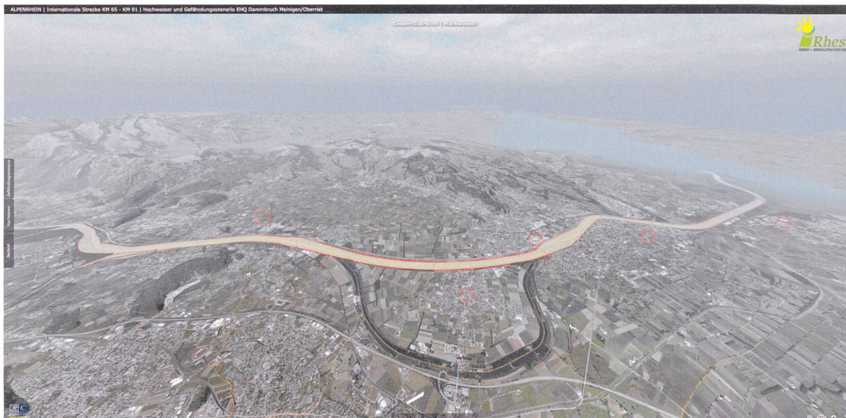
Visualisierung des Projektgebiets (Kilometer 65–91) im Fall eines HQ_{100} (= 3100 m 3 /s) im heutigen Bestand ohne Ausbau durch Rhesi. In der Bildmitte der Diepoldsauer Durchstich, rechts der Bodensee; Fließrichtung von links nach rechts.
