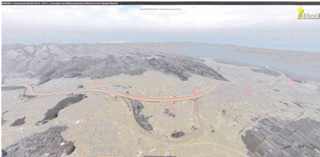
Visualisierung der im Fall eines Dammbrochs gefährdeten Bereiche innerhalb des Projektgebiets (Kilometer 65–91). Die Grafik stellt im Sinn einer Gefahrenkarte eine Überlagerung verschiedener möglicher Dammbüche dar. In der Bildmitte der Diepoldsauer Durchstich, rechts der Bodensee; Fließrichtung von links nach rechts.
