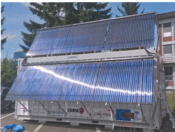
Systemaufbau: Der Prototyp ist in einen Container eingebaut, auf dessen Dach Solarthermiekollektoren montiert sind.
