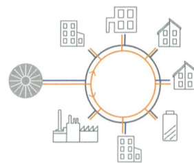
Entwicklung der thermischen Netze: zentral und unidirektional (oben) zu dezentral und bidirektional (unten).
