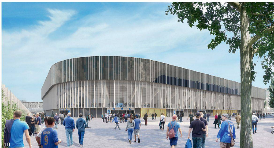
10–12 Unprätentiöse Robustheit: «Direkt verwandelt» von Gigon Guyer Architekten. Der Dachrand ist mit PV-Modulen bestückt, der eingezogene Sockel verkleinert die Grundfläche des Stadions. Dazwischen – vor dem «Stadtbalkon» genannten Umgang – spannt ein Metallgeflecht mit dem Stadionnamen
