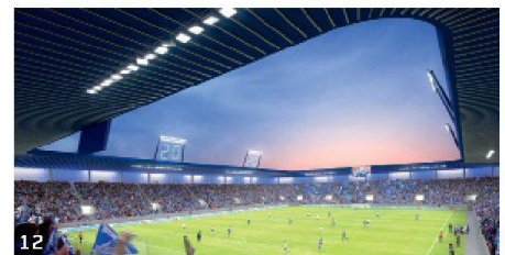
10–12 Unprätentiöse Robustheit: «Direkt verwandelt» von Gigon Guyer Architekten. Der Dachrand ist mit PV-Modulen bestückt, der eingezogene Sockel verkleinert die Grundfläche des Stadions. Dazwischen – vor dem «Stadtbalkon» genannten Umgang – spannt ein Metallgeflecht mit dem Stadionnamen
