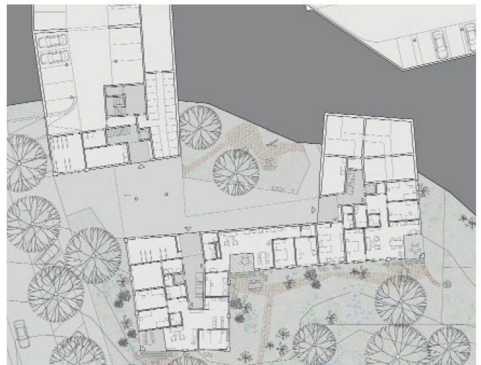
10 Grundriss Sockelgeschoss, Mst. 1:800: Hauseingänge, vier Wohnungen
