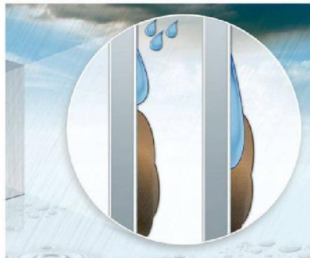
Alcoa Architectural Products bringt mit «Reynobond with EcoClean» eine Aluminium-Fassadeplatte auf den Markt, die mithilfe von Sonne und Feuchtigkeit sich selbst und die umgebende Luft von Schmutz- und Smogpartikeln reinigt. Die Titandioxid-Beschichtung «EcoClean» funktioniert wie ein Katalysator: An der Oberfläche bilden durch das UV-Licht frei gewordene Elektronen Radikale, die organische Substanzen wie Vogelkot, Moose, Abgase und Smogpartikel zersetzen.
