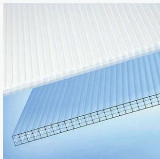
Mit der neuen Vierfach-Stegplatte Makrolon multi UV 4/10-6 erweitert Bayer Sheet Europe sein Portfolio der energiesparenden transparenten und transluzenten Polykarbonatplatten. Durch die einzigartige Y-Struktur der Platte sowie ihren engeren Stegabstand von 6 mm ist sie besonders trag- und widerstandsfähig gegen physikalische Einwirkungen wie Hagel oder Schneelast.
