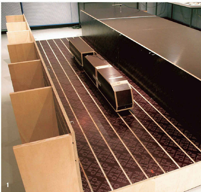
1 Masstabsmodell 1:16 zur Untersuchung der Schallausbreitung in Eisenbahneinschnitten (Bilder: Empa)
