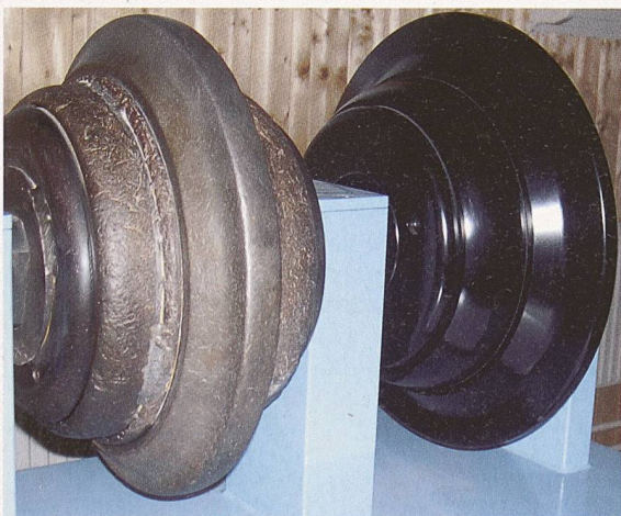
Links abgenutzter, rechts neuer Meissel aus dem Bohrkopf einer Tunnelbohrmaschine (Durchmesser der Meissel ca. 50 cm)
