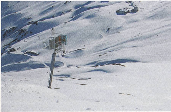
Ortsfeste Lawinensprenganlage: Sprenganlage Inauen-Schätti auf Davos Parsenn. Die offene Türe ist bereit zum ferngesteuerten Auswurf der Ladung
