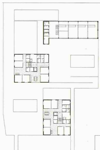
2. Obergeschoss: oben das ehemalige Fabrikgebäude, unten die zwei Wohnerverweiterungen
