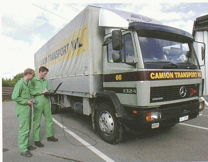
Umtec-Ingenieure kontrollieren via Laptop die Regelung eines mobilen Entstickungssystems.
