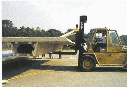
FRP-Träger Smith Road Bridge (Bild: Martin Marietta Composites)
