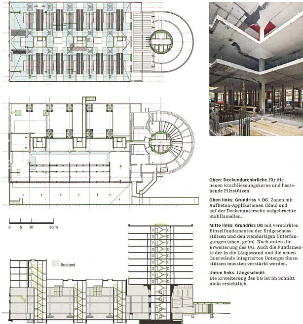
Im Bereich ohne Untergeschoss wurden die Pilzstützen bis zur Unterkante der Bodenplatte aufbetoniert. Dadurch erhöhen sich die Biege- und Durchstanzwiderstände der bestehenden Einzelfundamente, und die Lasten werden unmittelbar abgefangen. Neue Mikropfähle durchdringen die bestehenden Fundamente und leiten ihre Lasten tiefer in den Baugrund ein.
