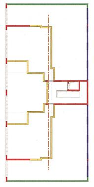
Die verschiedenen Systemkomponenten des neuen Tragsystems des Aufbaus Süd im Grundriss (links) und Axonometrie der zusätzlichen drei Stockwerke (unten).
