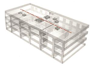
henden Decken im Verbund wirkt. Die Applikation zusätzlicher Stahllamellen auf der Deckenunterseite im Feldbereich erzielte eine Erhöhung des Biegewiderstands. Örtlich kam eine Durchstanzbewehrung zum Einsatz.
