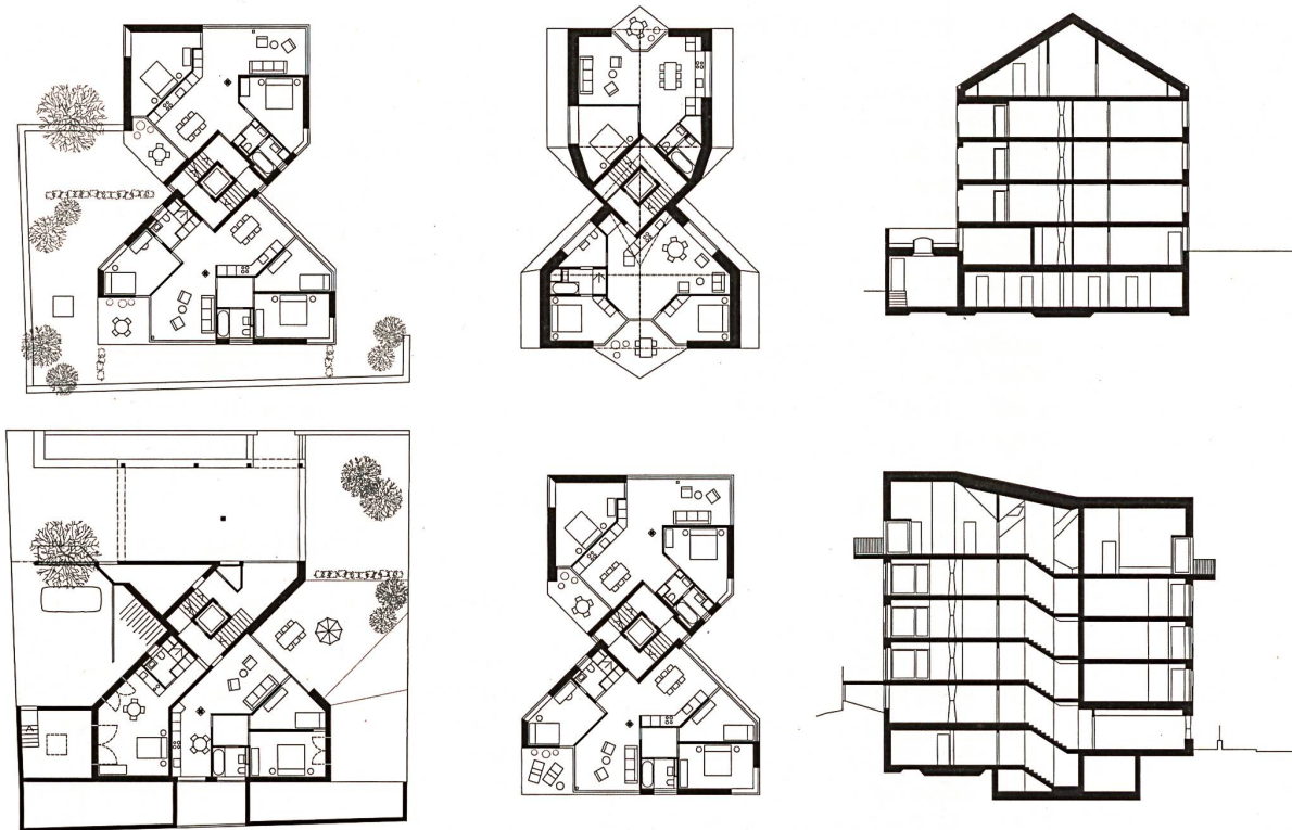
Grundrisse 1:500: Eingangshalle, 1. OG, 2.–3. OG, Dachgeschoss.
