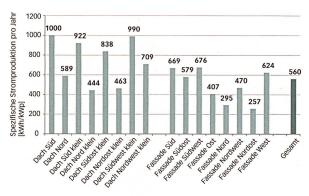
Spezifische Stromproduktion pro Jahr, Beitrag der einzelnen Dach- und Fassadenflächen. Aufgrund der Messungen der letzten Monate wird prognostiziert, dass der Gesamtertrag ca. 56000 kWh pro Jahr betragen wird. Zum Vergleich: Eine vierköpfige Familie verbraucht im Durchschnitt jährlich ca. 3000 kWh.
