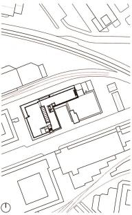
Vom Dachrand leicht zurückversetzt, folgt die Aufstockung dem bestehenden L-förmigen Gebäudeumriss.
