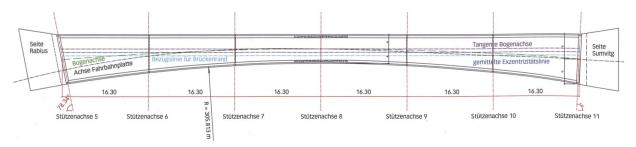
Einmittung Brückenachse in Strassenlinie: Der Bogenrand verläuft talseitig gerade und bergseitig gekrümmt. Die radial verlaufende Bogenachse mitteten die Ingenieure in die aus Geraden, Klothoiden und einem Radius bestehende Strassenlinie ein. So minimierten sie die statisch ungünstige exzentrische Belastung des Bogens.
