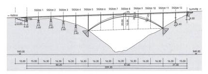
Längsschnitt: Der sichelförmige Bogen spannt 97.8 m mit einem Stich von 16.9 m über die Val Mulinaun, womit die Bogenkämpfer ausserhalb der Lawinenzone stehen.
