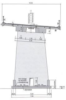
Typischer Querschnitt einer Stütze.
