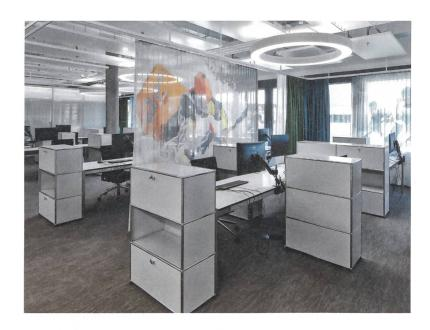
den sehr guten Schallabsorptions-Alpha-Wert 0.60 verantwortlich ist, und dem blickdichten «Tony», der über einen besonders hohen Schallabsorptions-Alpha-Wert von 0.85 verfügt. Das Langenthaler Familienunternehmen Création Baumann steht seit über 130 Jahren für innovative und hochwertige textile Lösungen und bietet mit rund 90 Textilien in über 2000 Farbstellungen weltweit die grösste Auswahl an schallabsorbierenden Dekorationsund Möbelstoffen an.
