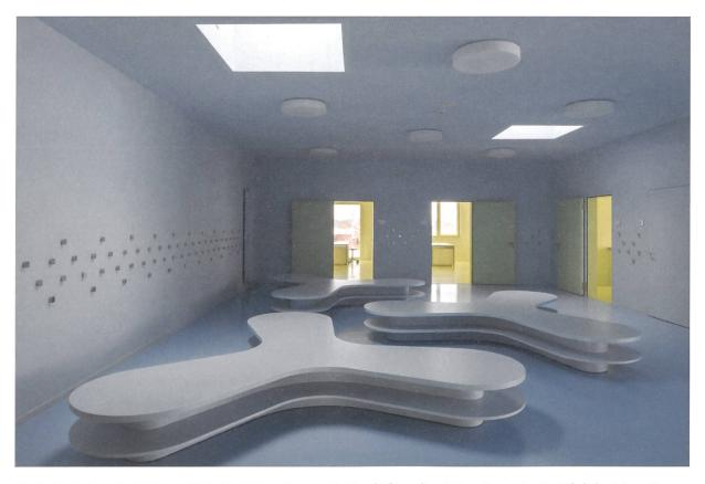
Garderobe in einer der zentralen Hallen des Obergeschosses. Alle Oberflächen – die mit Kunstharz belegten Möbel, der Polyurethanboden, der Gips an Wänden und Decken sowie die Heizkörper – bilden einen monochromen Hintergrund in Hellblau, was dem Raum eine wohltuende Ruhe verleiht (Wand und Decke: NCS S 1020-R90B; Boden: NCS S 1040-R90B).
