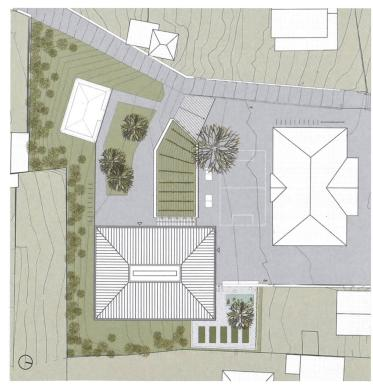
Situation. Das zweischalige Betondach des Neubaus (unten links) fungiert mit seinen Oberlichtern als «fünfte Fassade», Mst. 1:800.
