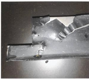
An einem Metallbauteil löst sich die Lackierung.
