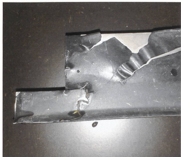
An einem Metallbauteil löst sich die Lackierung.
