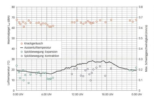
Typischer Tagesverlauf maximaler Knackgeräusche und Korrelation mit Schallereignis: Der getriggerte Schallpegel liegt über den Anforderungen an maximale Schallpegel von Knackgeräu schen. Bei dieser «Einzahlbeurteilung» gemäss SIA 181:2006 gilt es zu erwähnen, dass sie lediglich auf dem Mittelwert aller Ereignisse basiert, dass die «sinngemässe» Beurteilung einen Spielraum offen lässt und dass eine Beurteilung der Maximalwerte und der Häufigkeit der Ereignisse nicht erfolgte.
