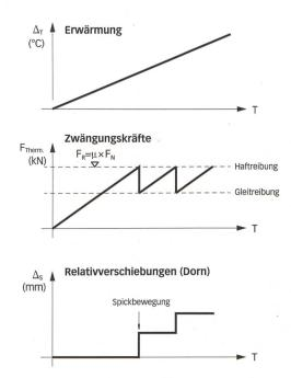
**Verschiebung in Dornlängsrichtung** (bei Fassadenecken): Unterschiedliche Wärmeausdehnungen verschiedener, mit einem Dorn verbundener Bauteile führen zu Zwängungen. Diese entspannen sich im Dorn ruckartig, sobald die Rückhaltekräfte F<sub>R</sub> überwunden werden. Die dabei entstehenden Luftdruckschwankungen können als Knackgeräusche wahrgenommen werden.
