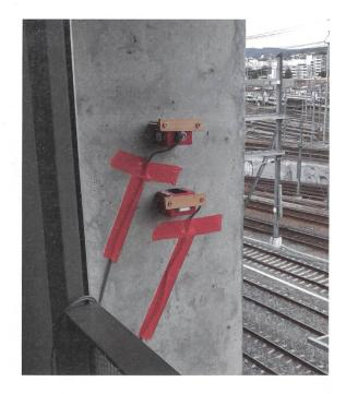
Die Spickbewegungen treten gleichzeitig mit den Knackgeräuschen auf. Die Messinstrumentierung nimmt beides auf: Horizontale Schwinggeschwindigkeitssensoren erfassen die Bewegung der Tragstruktur direkt an der Fassade, während ein Mikrofon im Innenraum (nicht im Bild) den hörenden Menschen simuliert und den abgestrahlten Körperschall bzw. das Knacken aufnimmt.
