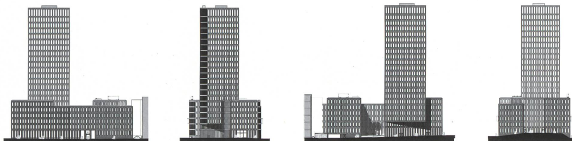
Unterschiedliche Ansichten des Grosspeter Towers von links nach rechts: Nord, Ost, Süd und West. In der Ansicht Süd – der dem Bahnareal zugewandten Seite – öffnet sich ein Innenhof, der den Hotel- vom Bürobereich trennt, Mst. 1:2000.
