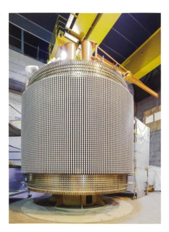
Rotor eines der vier Motorgeneratoren. Ein Rotor allein wiegt 330 t und besteht aus 0.5 mm starken, aufeinandergeschichteten Blechen.
