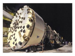
Tunnelbohrmaschine zur Erstellung des Zugangsstollens 1.
