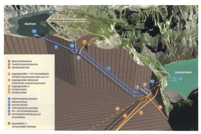
Visualisierung der Anlagen des Pumpspeicherwerks Limmern. Der Talboden und die Bauseilbahn 1, die von Tierfehd zum Chalchtrittli (Beginn des bestehenden Zugangsstollens zum Limmernsee) führte, ist nicht mehr im Bild ersichtlich.
