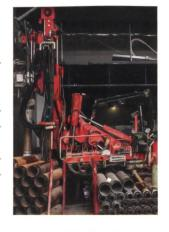
eine spezielle Pfahlarmierung entwickelt, die es erlaubt, Zug- und Druckkräfte auf Bemessungsniveau von 1900 kN aufzunehmen. Insgesamt werden ca. 2000 m Mikropfahlbohrungen vorgenommen. • www.jms-risi.ch
