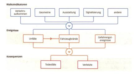
Ein Tunnelsystem wird in Segmente aufgeteilt und mit relevanten Risikoindikatoren charakterisiert. Für jedes Segment werden die Ereignisse für Unfall, Brand und Gefahrengut modelliert und die entsprechenden Konsequenzen abgeleitet. Die Aggregation aller Segmente ergibt das Gesamtrisiko.
