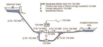
Kopswerk II: Funktionsweise des hydraulischen Kurzschlusses.
