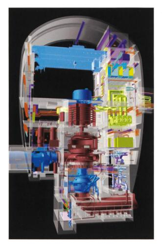
Nant de Drance: Visualisierung der 52 m hohen Maschinenkaverne mit Pumpturbine (braun), Kugelschieber (blau) darunter und Motorgenerator (braun/blau) in der Bildmitte.
