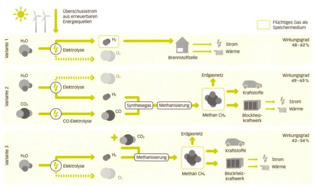
Überblick über die Stromspeichervarianten mit Power-to-Gas-Technik.
