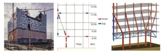
Aufstockung auf dem historischen Kaispeicher mit dem markanten Spalt zwischen Alt und Neu (links). Der Zwischenraum wird als öffentlich zugängliche Plaza mit Aussichtsplattform genutzt. Das Tragwerk weicht an dieser Stelle zurück: Geometrie und Kraftverlauf in den Stützen der Längsfassade und in den Schrägstützen (Mitte); Geometrie des Fassadenfachwerks mit verkürzten bzw. vorgespannten Diagonalen im Abfangträger an der Westspitze (rechts).
