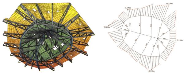
Schale des Saaldachs – ein Hut mit umlaufender Krempe: 21 auskragende Binder und ein geschlossener Ring bilden das räumliche Stahlfachwerk des hutförmigen Saaldachs (links). Rechts: Schnittkräfte (globale Biegemomente) in der Hutkrempe.
