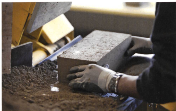
Mit einer Presse werden die Steine in die exakte Form gebracht.
