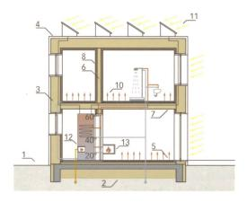
Niedrigstenergiehäuser kommen mit dem klimaaktiven Bausystem aus Holz und Lehm ohne Lüftungsanlage aus: Wärmestrahlung von aussen wird über die baulichen Öffnungen aufgenommen, bzw. Wärme wird über die Bodenheizung abgegeben, und täglich zweimaliges Stosslüften gewährleistet die Luftzufuhr.
