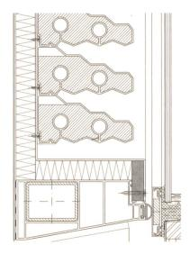
In den **Kühlflügel** eingebaute Rohre ermöglichen eine gleichmässige Vereisung.
