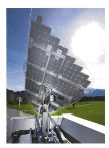
Der am Mock-up montierte PV-Flügel lieferte **2.9 Mal mehr Ertrag**, als es fix aufgestellte Zellen geschafft hätten.
