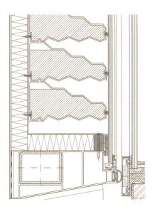
Die **Heizflügel** sind mit einer Glasplatte abgeschlossen, die die Rippen vor Wärmeverlust schützt.
