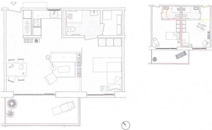
«Neoparc»: Grundrisse Alterswohnen (links, Mst. 1:150) und möglicher Umbau zum Pflegezimmer (rechts, Mst. 1:300. Neu rot, Abbruch gelb)
