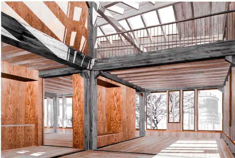
Auszeichnung: Die Anordnung von Kernen anstatt durchgehender Wände und eine auf das Gewerbegebiet des Basler Dreispitzareal abgestimmte Materialisierung erlauben eine zukünftig flexible Nutzung der neuen Gebäude am Leimgrubenweg .
