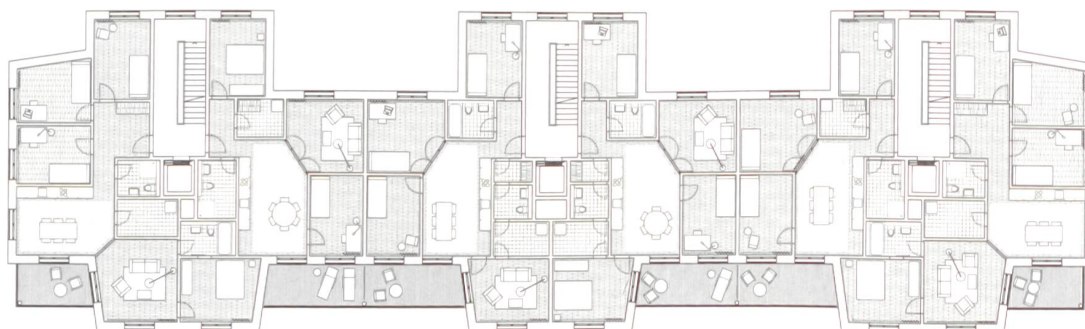
Die Dreiteilung des Grundrisses führt zu einem klaren Volumen und attraktiven Wohnungen. Grundriss im Mst. 1:400.
