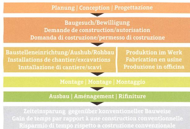
3 Schematische Darstellung der Bauzeitverkürzung durch die Vorfertigung ausgebauter Raumzellen im Werk (adaptiert vom Modular Building Institute). | Représentation schématique de l'accélération des chantiers grâce à la préfabrication de cellules spatiales en usine (adaptée par Modular Building Institute). | Rappresentazione schematica della diminuzione dei tempi di costruzione grazie all'impiego di moduli prefabbricati (elaborato da Modular Building Institute).
