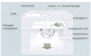
Mit dem Stereolithografie-Verfahren können grosse Objekte mit hoher Oberflächengüte hergestellt werden. Ein UV-Laser härtet ein flüssiges Fotopolymer an seiner Oberfläche. Die Form wird durch das Absenken der Plattform aufgebaut. Eine grosse Palette an Materialien ermöglicht spezifische Eigenschaften. Allerdings funktioniert die Technologie nur mit Fotopolymeren, die mit der Zeit altern und somit nicht dauerhaft sind.
