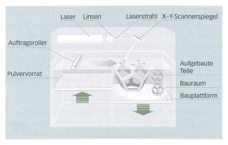
Auf die Bauplattform der Laser-Sintering-Maschine wird eine Schicht Plastikpulver aufgetragen. Durch die Energie des Lasers schmilzt das Pulver im definierten Bereich. Nach dem Absenken der Bauplattform wird die nächste Schicht aufgetragen, und der Vorgang wiederholt sich. Laser-Sintering benötigt keine Stützstrukturen. Mit diesem Verfahren werden Prototypen in Standardmaterialien für Form-, Pass- sowie Funktionstests gebaut.
