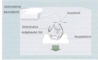
Vor allem Wachsmaterialien werden beim Material-Jetting verwendet. Dieses Verfahren nutzt Tintenstrahldruckköpfe, um geschmolzenes Material aufzubringen, das anschliessend abkühlt und erstarrt. Die Objekte werden Schicht um Schicht aufgebaut. Es wird eine Stützstruktur benötigt, um Überhänge abzustützen. Die gedruckten Körper werden meist als Prototypen oder Modelle für den Feinguss verwendet.
