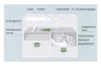
Beim Laser Melting brennt der Laser die Kontur der gewünschten Form in eine dünne Schicht Metallpulver. Der Aufbau erfolgt schichtweise. Es können Objekte in Standardmetallen mit hoher Dichte hergestellt werden. Eine Nachbearbeitung ist wie bei Schweissteilen möglich. Das Verfahren ist eher langsam und teuer, die Qualität der Oberflächen ist mittel.
