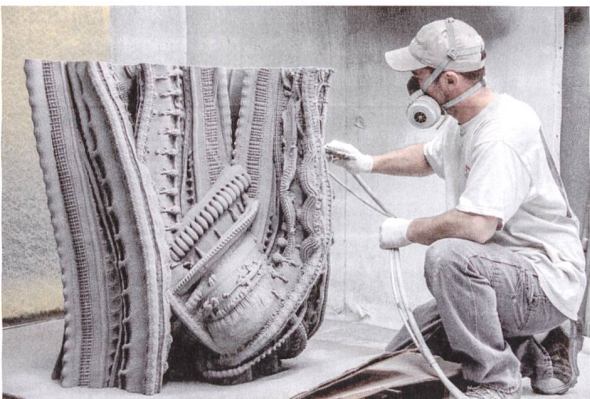
Die Produktion von «Digital Grotesque»: Vor allem komplexe Bauteile können mit 3-D-Druck um ein Vielfaches schneller als mit herkömmlichen Verfahren produziert werden.
