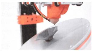
Architekturstudierende der ZHAW haben 3-D-Druck zum Modellbau eingesetzt. Am Institut für Mechatronische Systeme haben indessen zwei Masterstudierende ein neues **sechsachsiges 3-D-Druck-Verfahren** entwickelt, das auch ohne zusätzliche Stützstruktur stark überhängende Geometrien fertigen kann.
