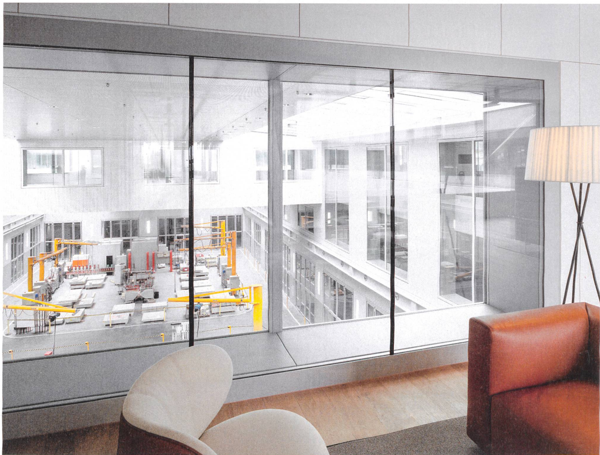
Prüflabor und Besprechungszone sind eng miteinander verzahnt – eine Nachbarschaft mit Herausforderungen: Schall und Erschütterungen mussten eliminiert werden.
