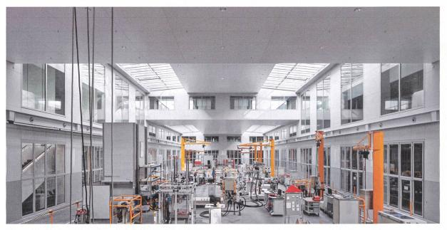
Die Versuchshalle ist das Herz des Gebäudes. Hier werden Bauteile traktiert und zerlegt. Um Emissionen zu vermeiden, sind die Testfelder der Halle bauphysikalisch sorgfältig vom restlichen Gebäude getrennt. Darum herum sind Büros und Labors angeordnet.
