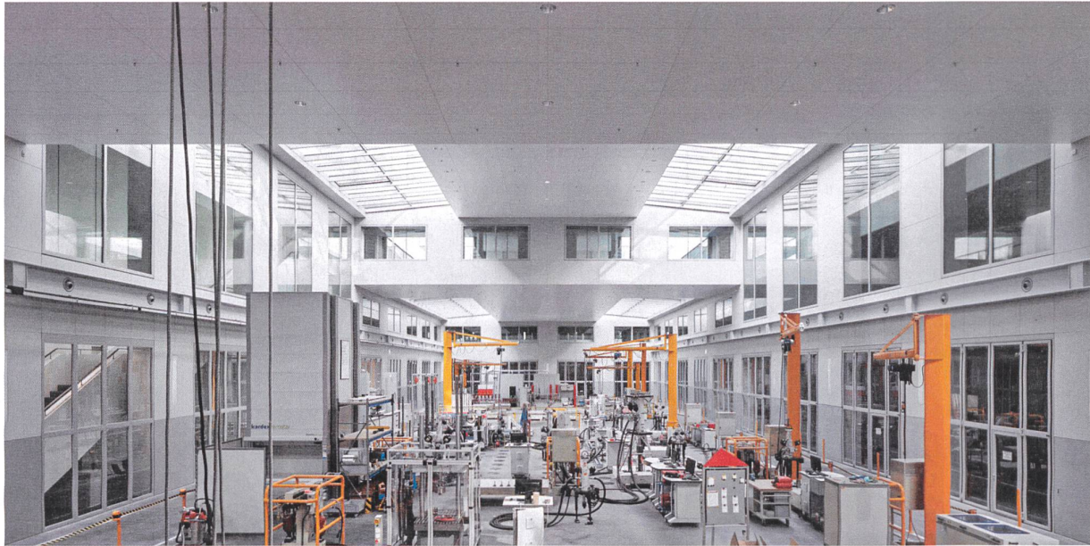
Die Versuchshalle ist das Herz des Gebäudes. Hier werden Bauteile traktiert und zerlegt. Um Emissionen zu vermeiden, sind die Testfelder der Halle bauphysikalisch sorgfältig vom restlichen Gebäude getrennt. Darum herum sind Büros und Labors angeordnet.
