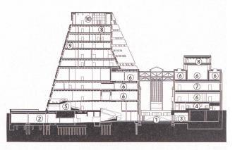
Querschnitt, Mst. 1:2000. Die abfallenden Fassadenflächen bilden in jedem Geschoss neue Grundrissflächen ohne rechte Winkel, was viele vorfabrizierte Tragelemente in unterschiedlichen Abmessungen generiert. 1 Turbinenhalle; 2 südlicher Tank; 3 Hauptshop; 4 Kino; 5 Bar; 6 Sammlung; 7 Ausstellung; 8 Restaurant; 9 Lager; 10 Aussichtsterrasse.
