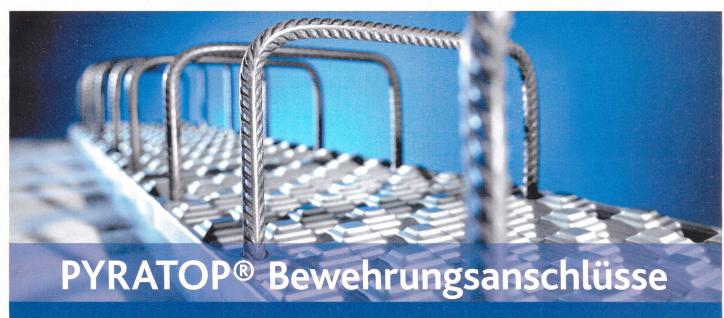
Die Pyramidenform des PYRATOP®-Blechprofils gewährleistet eine biaxiale Schubkraftübertragung quer und längs zur Arbeitsfuge. Zusätzlich zur Haupttragrichtung können Kräfte in sekundärer Richtung, zum Beispiel aus Erdbeben, Wind oder Erddruck, sicher übertragen werden. Die schachbrettartig angeordneten Pyramidenstümpfe gewährleisten ein Maximum an richtungsunabhängiger Schubübertragung. Es ist kein Aufrauen von Arbeitsfugen oder Anordnung zusätzlicher Dorne erforderlich.
