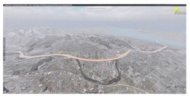
Visualisierung des Projektgebiets (Kilometer 65–91) im Fall eines  $\mathrm{HO}_{100}$  (= 3100  $\mathrm{m}^3$ /s) im heutigen Bestand ohne Ausbau durch Rhesi. In der Bildmitte der Diepoldsauer Durchstich, rechts der Bodensee; Fliessrichtung von links nach rechts.
