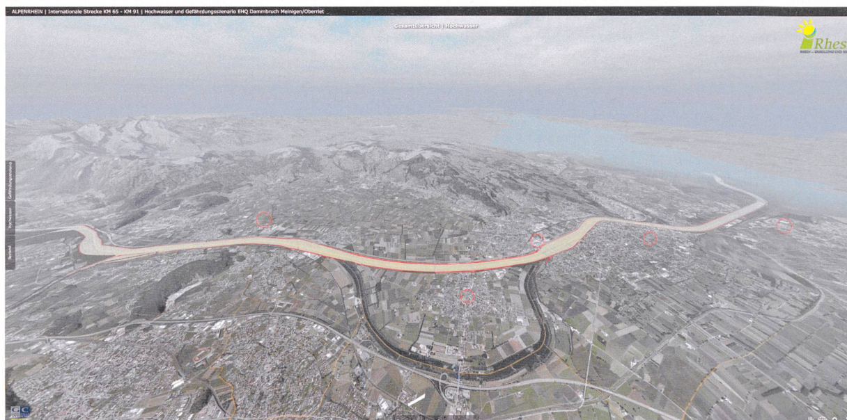
Visualisierung des Projektgebiets (Kilometer 65–91) im Fall eines HQ_{100} ( = 3100 \text{ m}^3/\text{s} ) im heutigen Bestand ohne Ausbau durch Rhesi. In der Bildmitte der Diepoldsauer Durchstich, rechts der Bodensee; Fliessrichtung von links nach rechts.
