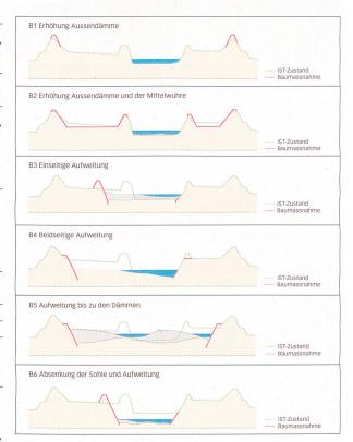
Basisvarianten der Fliessquerschnittserhöhung am Alpenrhein. Die Varianten mit einer Erhöhung der Aussendämme (B1, B2) führen zu höher liegenden Hochwasserspiegeln und grösseren Dammbeanspruchungen. Eine Absenkung der Sohle (B6) zieht tiefere Grundwasserspiegel nach sich und hat Auswirkungen auf das Längsgefälle des Flusses. Daher werden diese Varianten nicht mehr weiterverfolgt.
