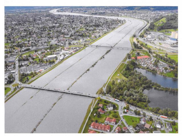
Alpenrhein am 16. Juni 2016: Ab einem **Abfluss von 1200 m³/s** strömt Wasser aus dem Mittelgerinne in die Rheinvorländer. Auf der linken Seite Lustenau, auf der rechten Seite oben die Autobahn A13 bei St. Margrethen auf dem Hochwasserdamm und gleich dahinter der **Rheintaler Binnenkanal**, der in den Flusslauf des Alten Rheins mündet und diesen mit Wasser versorgt.
