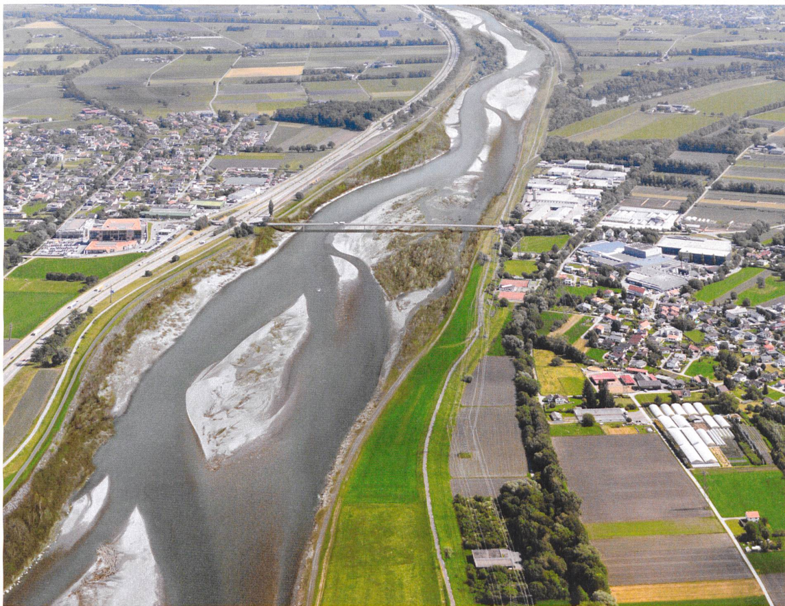
Der aktuelle Zustand des Alpenrheins mit landwirtschaftlicher Nutzung der Vorländer (oben) sowie die Visualisierung einer möglichen Gerinneverbreiterung innerhalb der bestehenden Aussendämme unter Berücksichtigung der Trinkwasserbrunnen von Mäder (unten). Links Kriessern, rechts Mäder, Blickrichtung nach Norden.
