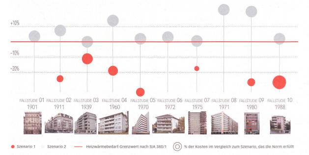
Ein Kostenvergleich bei Sanierungsmassnahmen im Forschungsprojekt «eREN» der HES-SO: An den zehn untersuchten Typologien zeigte sich, dass die letzten 20% Energieeinsparung nach SIA 380/1 teilweise mit sehr hohen Kosten verbunden sind.
